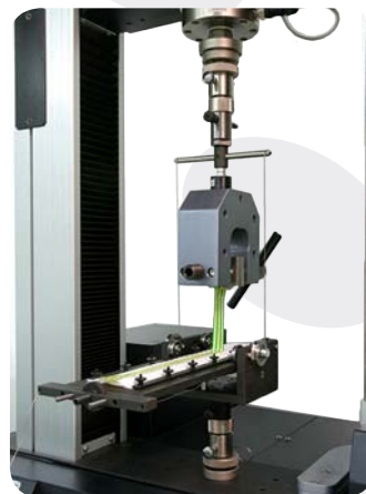
▲ Despegue adhesivos a 90° Adhesives 90° pull off test
