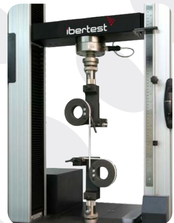
▲ Tracción de cuerdas Rope tensile testing
