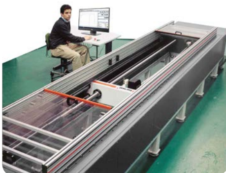
▲ Tracción de cables y cuerdas Cables and ropes tensile testing
